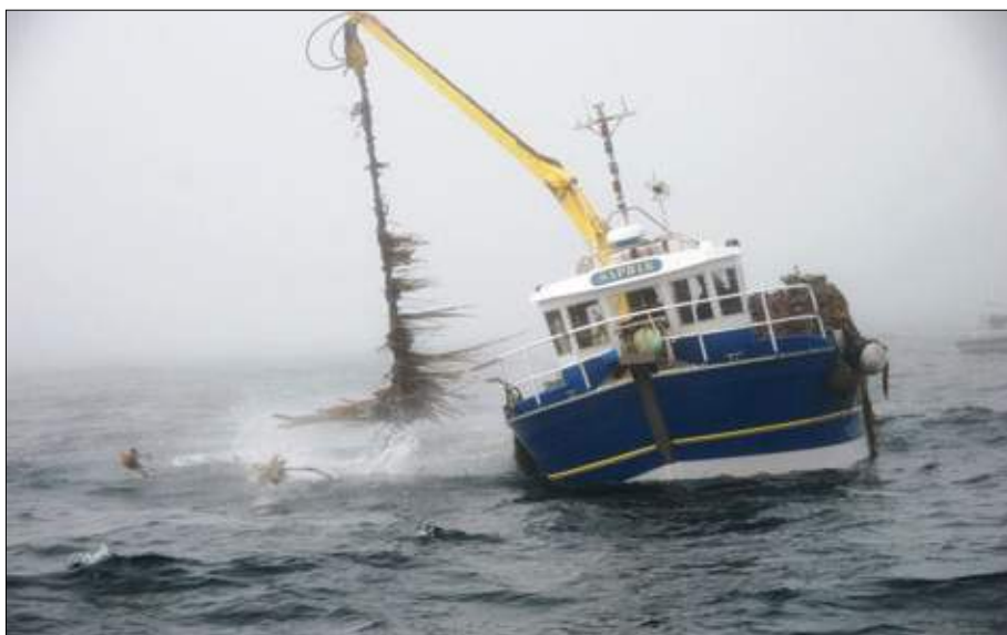
Exploitation de Laminaria digitata (le tali ) au moyen d'un scoubidou.
