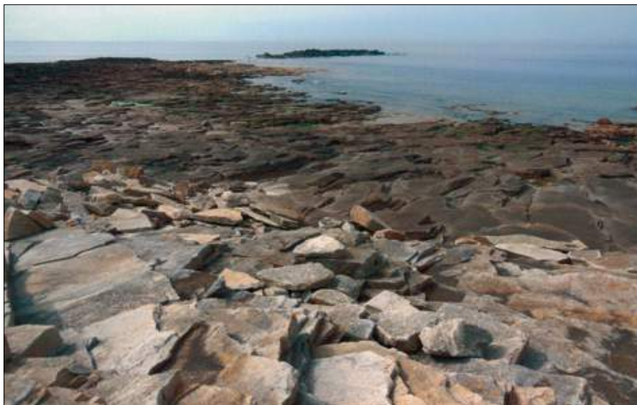
Carrière littorale sur la côte sud-ouest de Molène. Débitage facilité par la structure en dalles du granite. La faible épaisseur des bancs ne permet pas l'obtention de pierres de taille en grand appareil.
