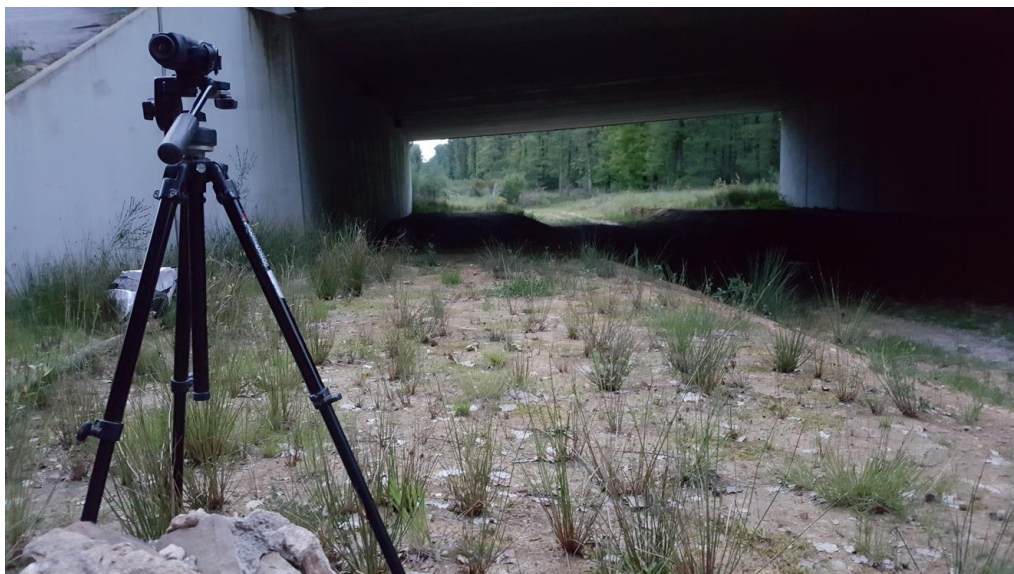
Figure 14 : Lunette thermique installée au passage inférieur de la forêt d'Araize
