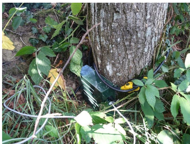
Figure 4 - Enregistreur SM2BAT+ avec son boîtier visant à le protéger du vol ou de la détérioration
