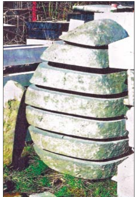
Boule de dolérite sciée pour la fabrication de monuments funéraires. Entreprise Maillard en Ille-et-Vilaine (1994).
