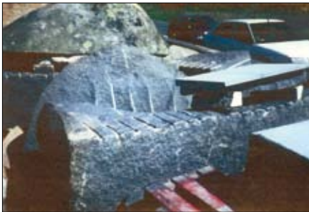
Boules de diorite de Plounévez-Lochrist, en cours de fente dans l'entreprise Crenn à Plouescat.
