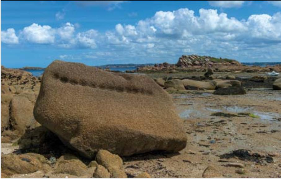
Callot. Fente abandonnée d'une boule de granite par la méthode des coins.
