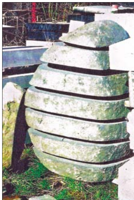
Boule de dolérite sciée pour la fabrication de monuments funéraires. Entreprise Maillard en Ille-et-Vilaine (1994).
