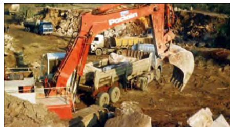
[5a et 5b] Carrière BGP-GAD à Ploumanac'h. Chargement de blocs rebutés de granite de La Clarté pour les enrochements du port de Saint-Quay-Portrieux (27/02/1989).
