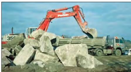
[5a et 5b] Carrière BGP-GAD à Ploumanac'h. Chargement de blocs rebutés de granite de La Clarté pour les enrochements du port de Saint-Quay-Portrieux (27/02/1989).
