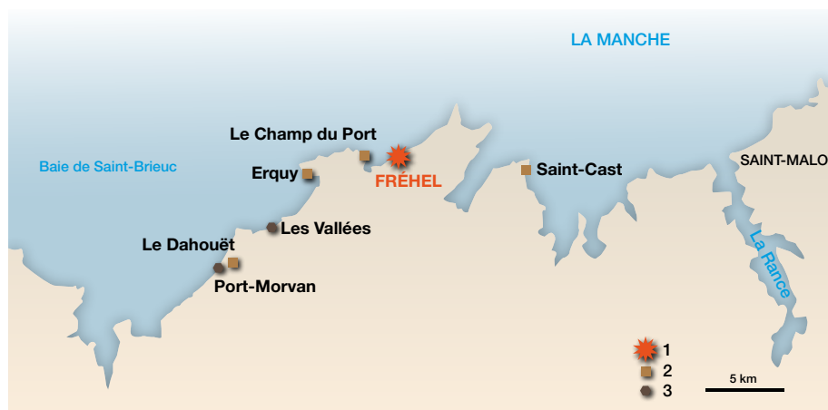
[Fig. 1] Emploi du grès de Fréhel (Côtes d'Armor) pour les enrochements littoraux. 1 : carrière ; 2 : ouvrages portuaires ; 3 : autres enrochements.
