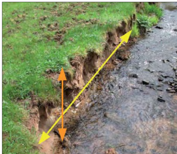
[5] Cartographie de l'érosion de la berge de la rivière : enregistrement des longueurs et hauteurs des berges récemment érodées
