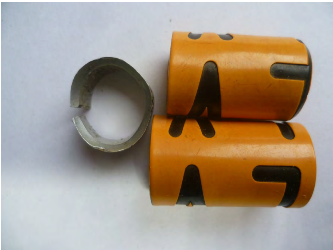
Photo 2 : on voit l'usure de la bague Darvic qui a frotté contre la bague métal. G. Derian
