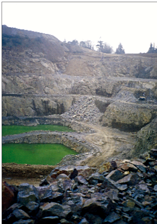
À gauche, dans la carrière de Ruvernison, l'orthogneiss, très fissuré, est exploité en plusieurs niveaux. À droite, énormes boules en granite de Plounéour-Menez un peu au nord de la Garenne.
