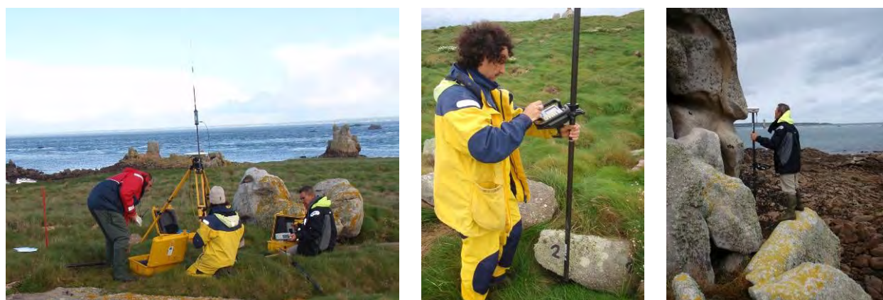
Positionnement des sites de reproduction grâce au DGPS en octobre 2008 : mise en place de la station fixe de référence sur Banneg et lever des sites avec les récepteurs mobiles
