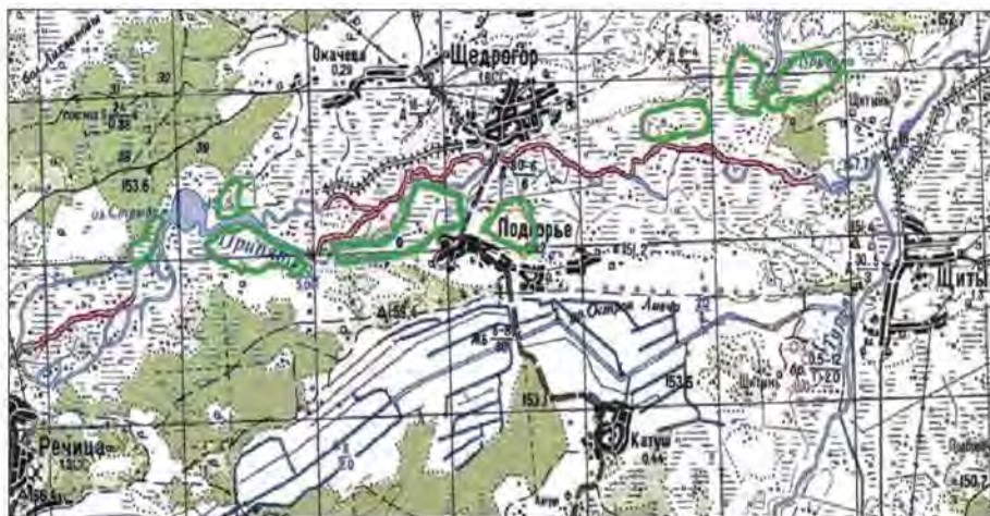
[2] Approfondissement du lit de la rivière Pripyat entre 2005 et 2007 (ligne rouge : portions de rivière où les travaux sont terminés ; les zones vertes : habitats du phragmite aquatique ; les zones bleues : points d'enregistrement des hauteurs d'eau).
