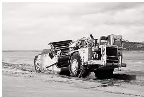
Ouverture du chenal artificiel du Yar à l'aide d'un engin de type "épilucheur".
