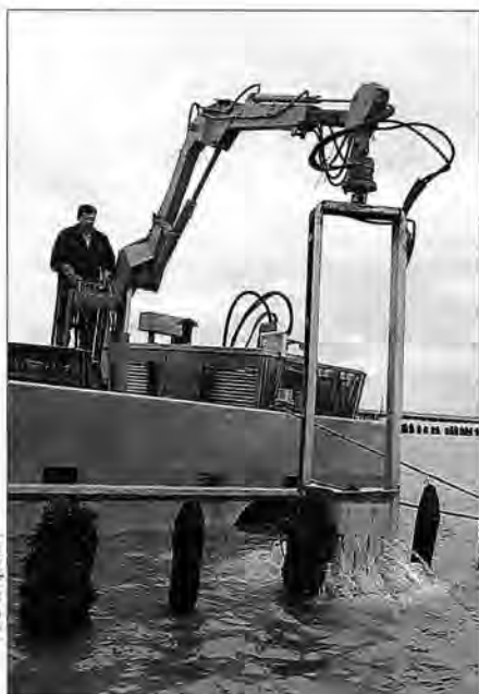
Pêche des moules sur les bouchots à l'aide d'une pêcheuse mécanique.
