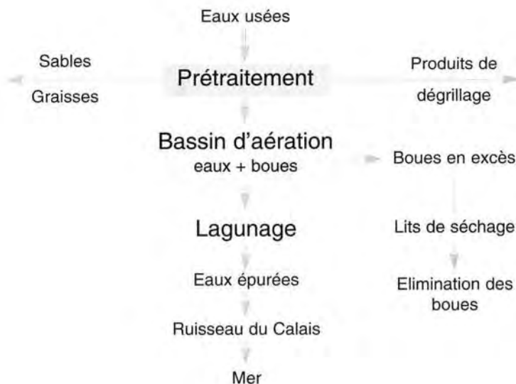
Schéma de fonctionnement de la station d'épuration de Saint-Michel-Chef-Chef.
