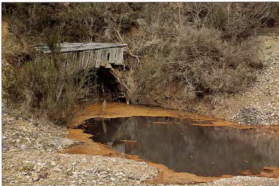
Eaux ferrugineuses au débouché de la galerie de recherche de Bodennec.
