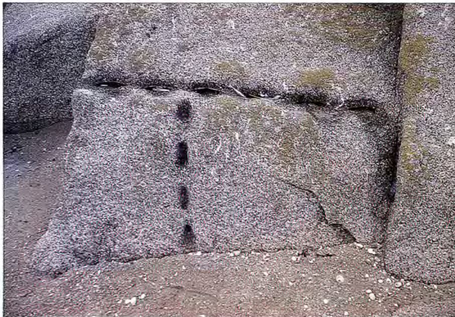
Ile Blanche en Saint Pol de Léon. Deux rangées de trous pour coin, disposées perpendiculairement, un peu au-dessus de l'estran.
