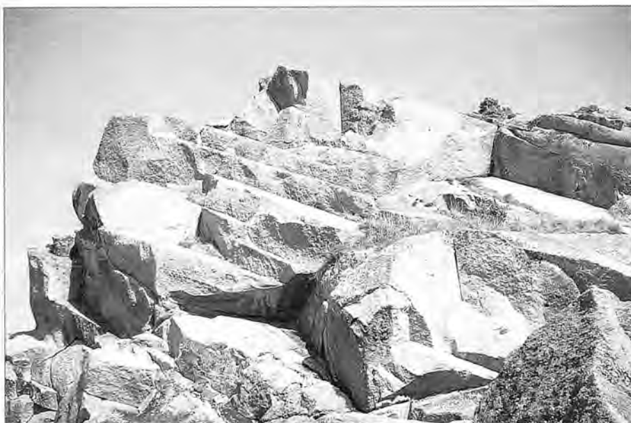
Poull Morvan, Callot. Au-dessus de l'estran. Exploitation par grands trous de perforation, facilitée par les diaclasses.
