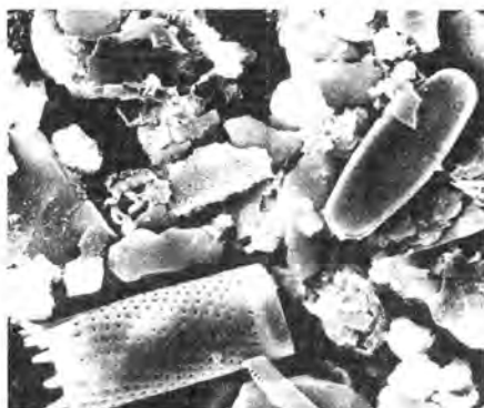
Fig. 4. Vue au microscope électronique à balayage (grossissement : 4 000) d'un échantillon de sédiment après destruction de la matière organique. Le cliché montre deux diatomées, l'une centrique, l'autre pennée, des débris organiques divers et quelques micas.
