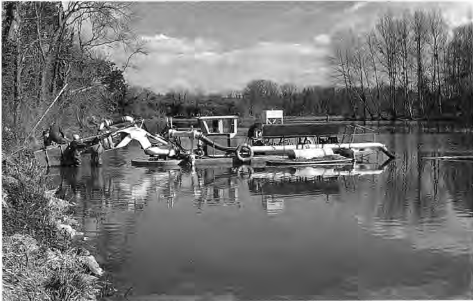
Dragage suceuse spécialement conçue pour le dévasement des retenues.
