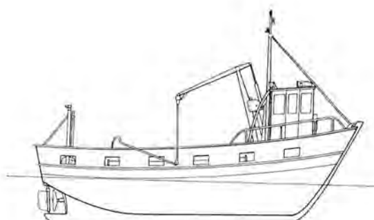
Fig. 6. — Bateau goémonier la génération des 9 mètres
