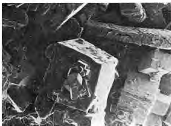
Cristaux de sel observés au microscope électronique à balayage ( G \times 50 ) : chlorure de sodium (formes cubiques) et chlorure de magnésium (en baguettes).
