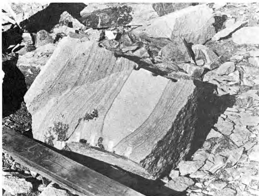
Fig. 4. — Le Roz en Logonna-Daoulas. Microdiorite quartzique. Fragment de boule débitée au marteau-piqueur montrant un cœur inaltéré et des dépôts concentriques d'hydroxydes et oxydes ferriques.
