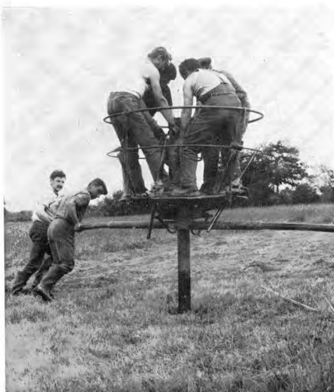
Fig. 39. — Exploration des alluvions à la sondeuse Banka.
