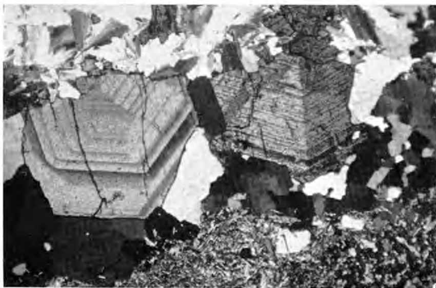
Photo 2. — L'observation au microscope polarisant (L.P. \times 32 ) met en évidence la structure zonée des cristaux de cassitérite de Saint-Renan, développés sur un liseré de muscovite.
