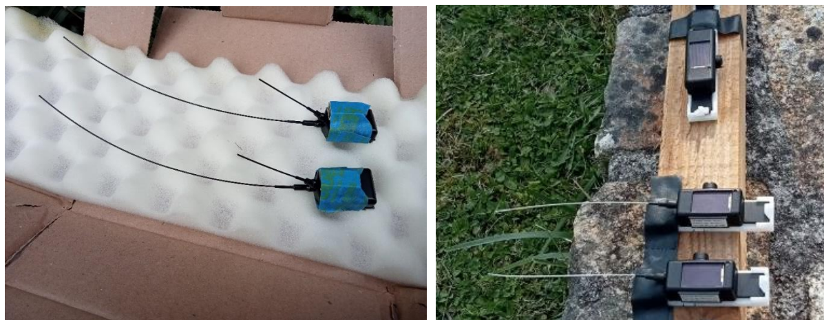
Figure 1. Balises GPS utilisées en 2025, modèle Xerius avec deux antennes (photo de gauche), modèle Ornitela OT10 (avec panneau solaire, photo de droite en haut) et modèle Ornitela OT9 avec panneau solaire et une antenne (photo de droite en bas) (clichés B. Cadiou).
