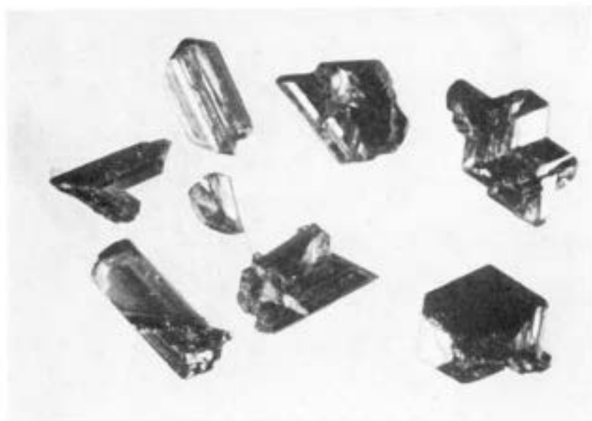
Fig. 41. — Rutile d'alluvion ( \times 16 )
