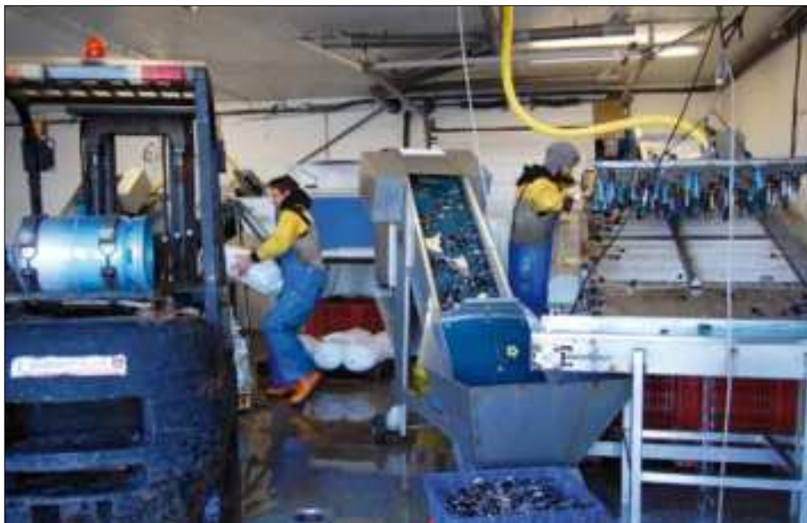
[3] Atelier de nettoyage et de calibrage des moules au pôle mer
